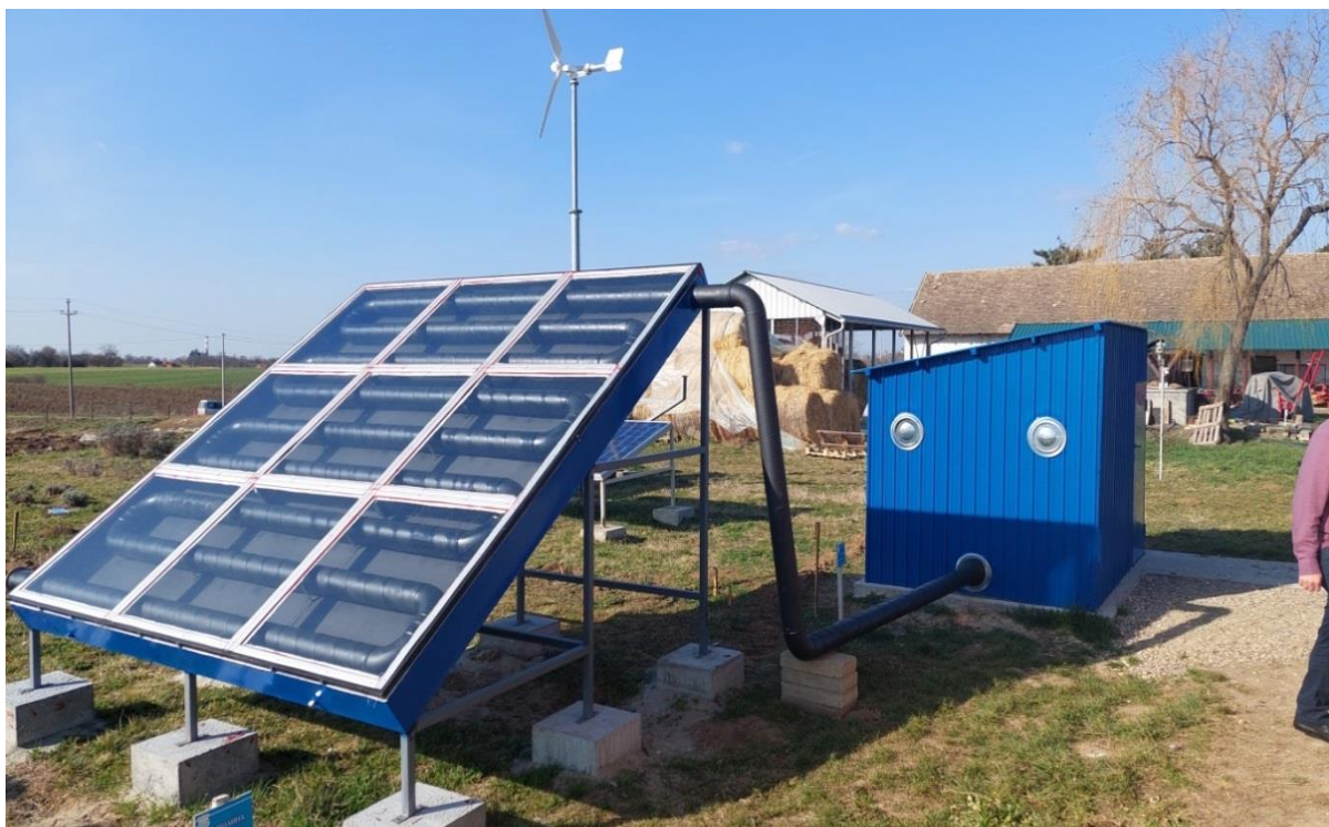
Слика 1. Изглед соларне сушаре с колектором енергије, топлотним складиштем и комором за сушење сировина
